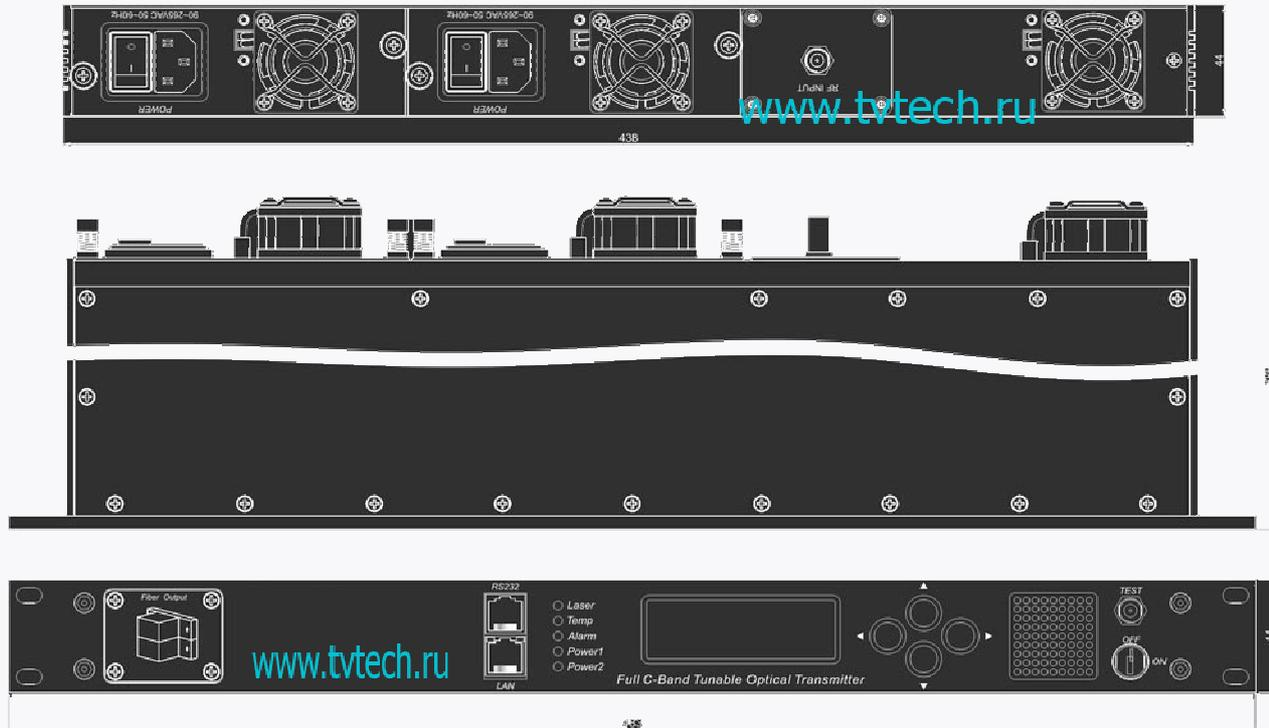
Модели оптического передатчика серии OT1550HQ-2x9
