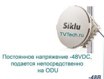
**Схема подключения РРЛ оборудования Siklu серии EH1200F с локальным питанием через инжектор PoE от сети переменного (220VAC) или постоянного тока -48VDC**
